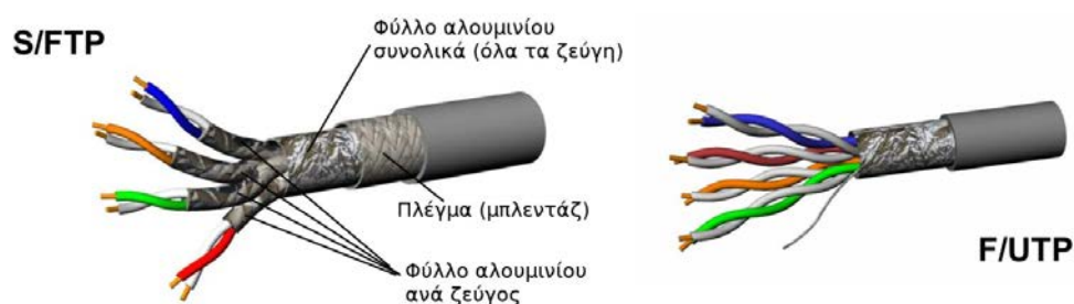
Εικόνα 2.4.1.η: Θωρακισμένα καλώδια συνεστραμμένων ζευγών.
